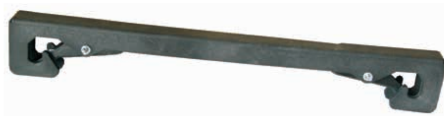
LVTT Materiál PP (polypropylén) s látkou zvyšujúcou odolnosť voči UV žiareniu. Drží káble v 350 mm vzdialenosti pomocou pružinového mechanizmu. Max. priemer kábla: Al - 10mm 2 alebo Cu - 70 mm 2
